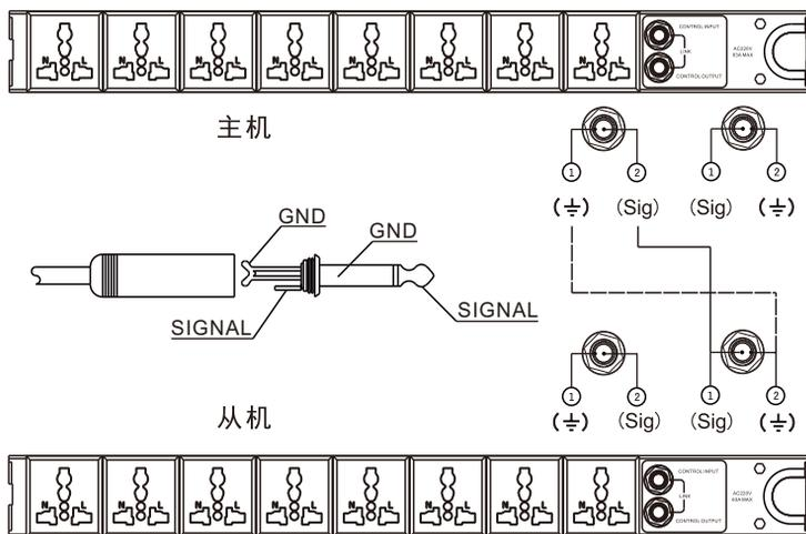
注意：联机时，通过主机控制从机，从机的按键开关需要在打开状态。
