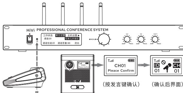
**单元对频：**主机与单元处开机状态→单元红外接收窗对准主机发射窗（IR）→转动电子菜单旋钮→单元设置→选择“通道”→设置好通道及信道→写单元并保存→单元屏幕提示按下按键接收信息→此时按下单元按键→对频完成。
